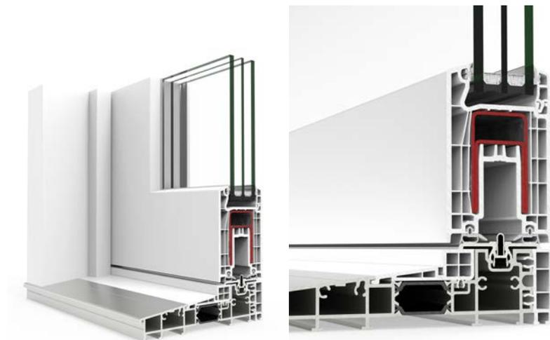
Sistema diseñado para cerramientos de grandes dimensiones con hojas hasta 3,3 m de ancho y 2,80 m de alto. Incorpora un sistema de herraje que eleva ligeramente la hoja al accionar la manilla y facilita el deslizamiento de las hojas en las maniobras de apertura y cierre. Presenta un marco de 170 mm de profundidad y una capacidad máxima de acristalamiento de 40 mm, ofreciendo unas destacadas prestaciones térmicas y acústicas.
